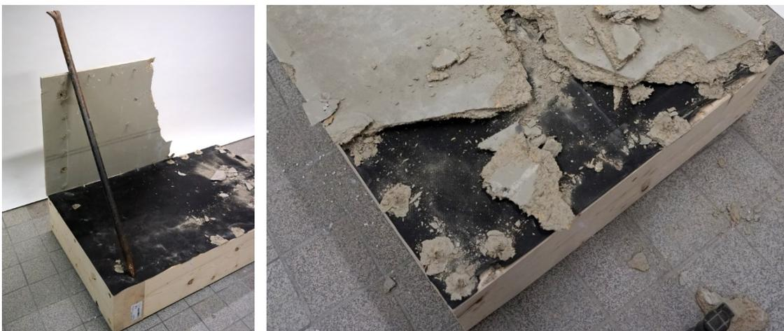
Abbildung 108: Trennung der zementgebundenen Spanplatte vom Holzständerwerk (eigene Darstellung)
