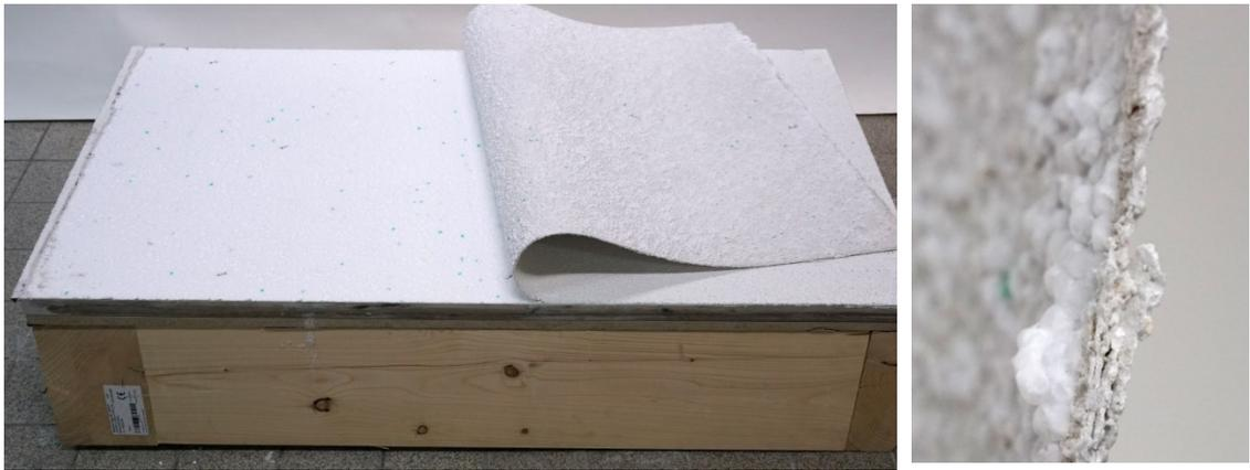
Abbildung 105: Trennung des Putzes mit Armierung von der EPS-Dämmplatte (eigene Darstellung)
