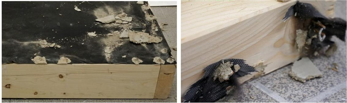
Abbildung 109: Trennung der Unterspannbahn vom Holzständerwerk (eigene Darstellung)
