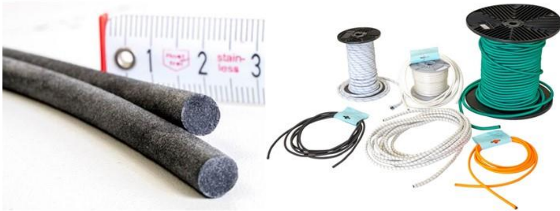
Abbildung 25 Links: Durch Profilextrusion hergestellte Rundschnüre (Durchmesser 6 mm) Rechts: Daraus hergestellte Gummiseile mit verschiedener Ummantelung
