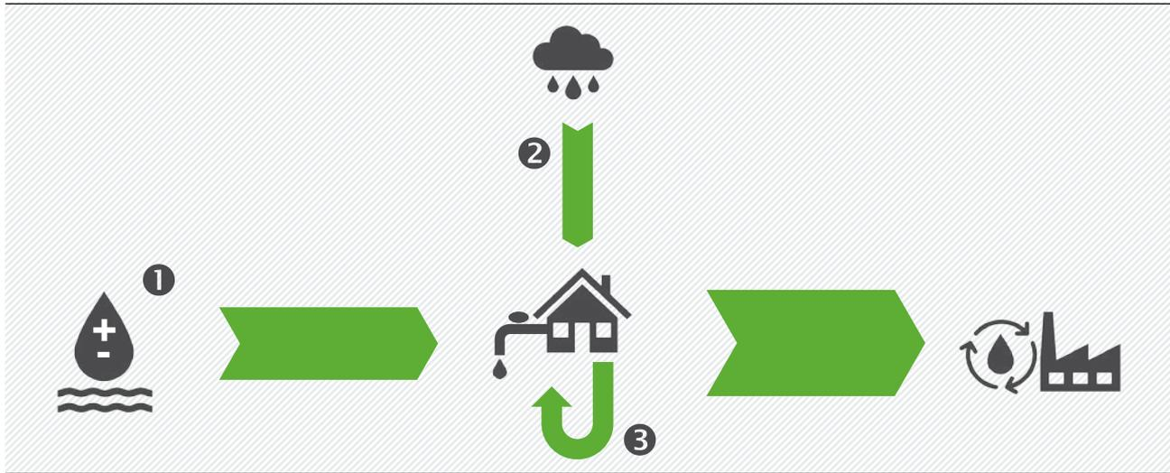
Der Wasserbedarf kann deutlich reduziert werden, wenn Regenwasser genutzt wird (2). Wird kein Regenwasser genutzt, muss der Bedarf meistens dem Grundwasser entnommen werden (1). Ferner liegen in der Grauwassernutzung weitere Einsparpotentiale für Trinkwasser (3 z. B. Grauwassernutzung für Toilettenspülung, zu Reinigungszwecken, für die Bewässerung).
