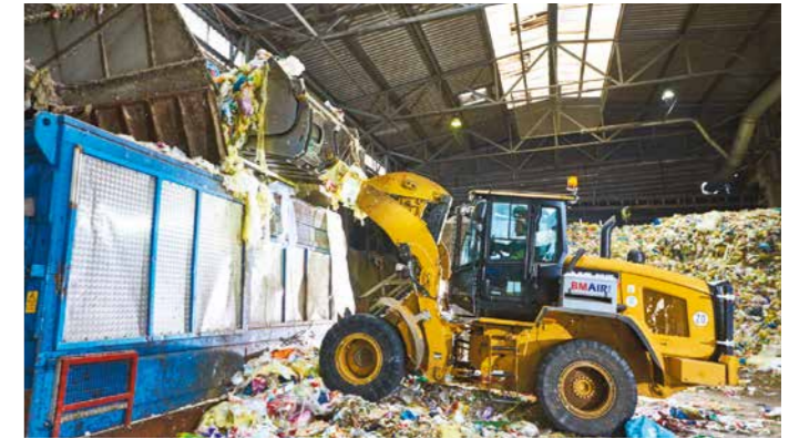
Befüllen Sortieranlage mit Gelber Sack-Sammlung, Quelle: Veolia
