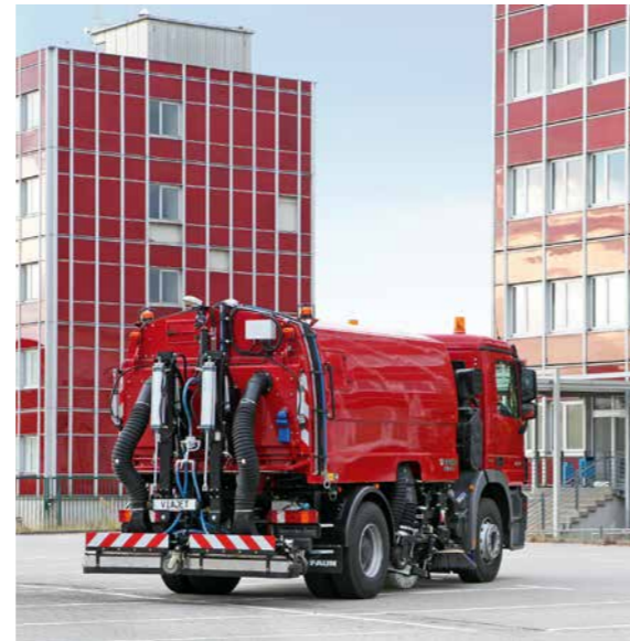
Kehrmaschine für Straße und Baustellen, Quelle: FAUN
