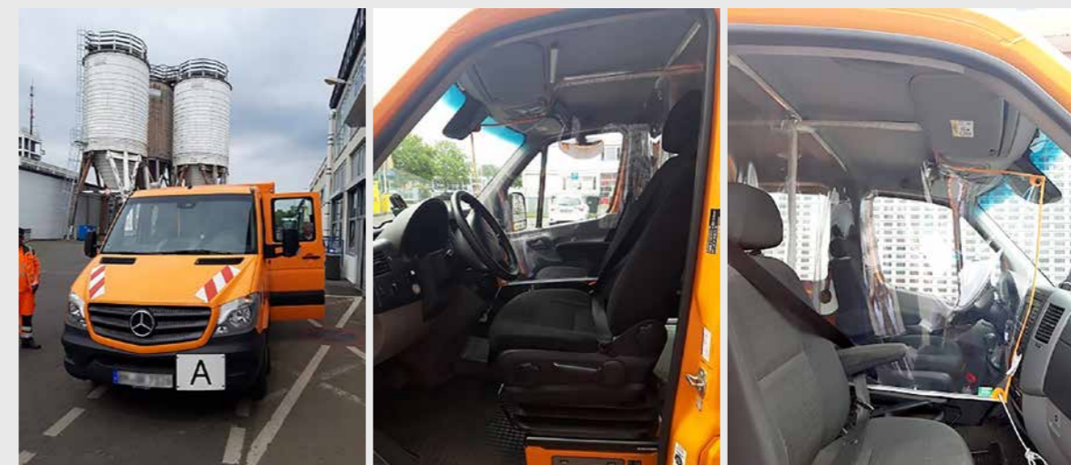
Abtrennungen im Fahrerhaus zum Mitarbeiterschutz, Quelle: bonnorange
