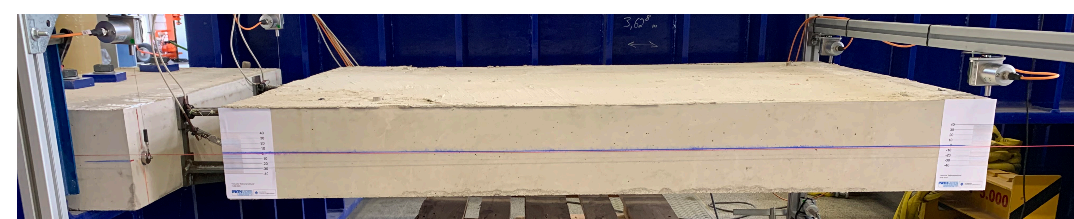
Abb. 3: Vorversuche zur Machbarkeitsuntersuchung thermisch getrennter Balkonanschlüsse
