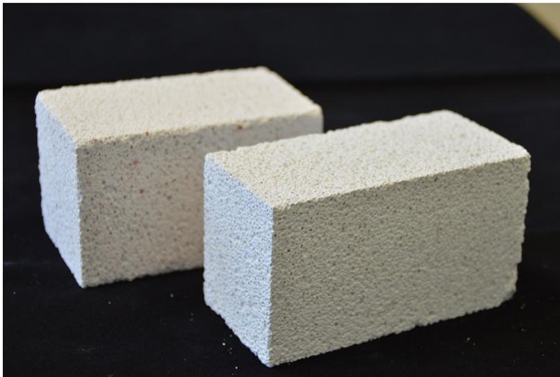
Abbildung 8: Porenbeton aus Ziegel (hinten), Porenbeton aus Kalksandstein (vorne)<sup>205</sup>
